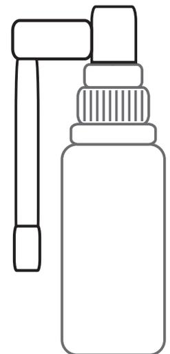
7. **Flasche verschlossen:** Sprühstange parallel zur Flasche, der Sprühkopf lässt sich nicht nach unten drücken.
