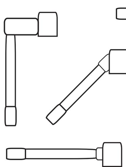
2. Nehmen Sie den beiliegenden Sprühkopf und drehen die Sprühstange in die Horizontale.
